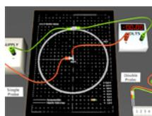
**ELECTRIC FIELD MAPPING APPARATUS**
